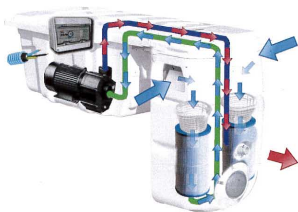
Schéma hydraulique du bloc filtrant (standard hors options)
